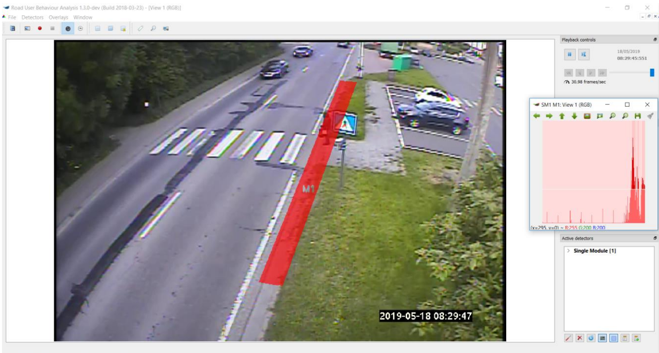
Figuur 13 Illustratie werking RUBA videoanalysesoftware.
